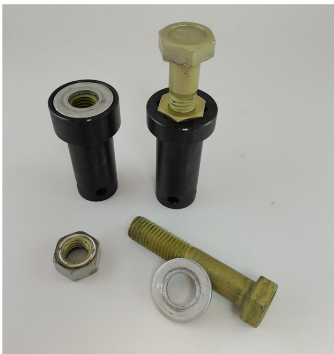
Conception de douille adaptée aux travaux sous tension , du prototype 3D au plan technique pour réalisation par Renault Tooling
