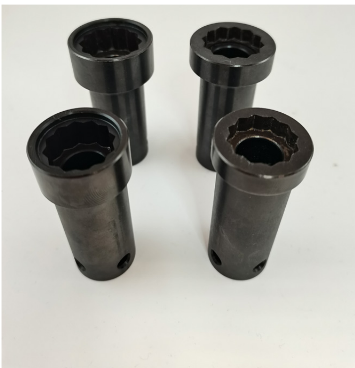
Conception de douille adaptée aux travaux sous tension , du prototype 3D au plan technique pour réalisation par Renault Tooling
